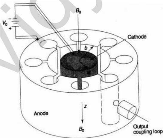
Fig. (a) : Cavity Magnetron
