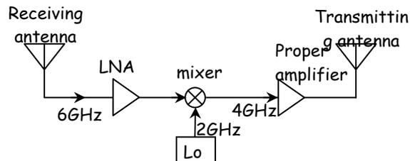
Fig. 1(b) : Block diagram
